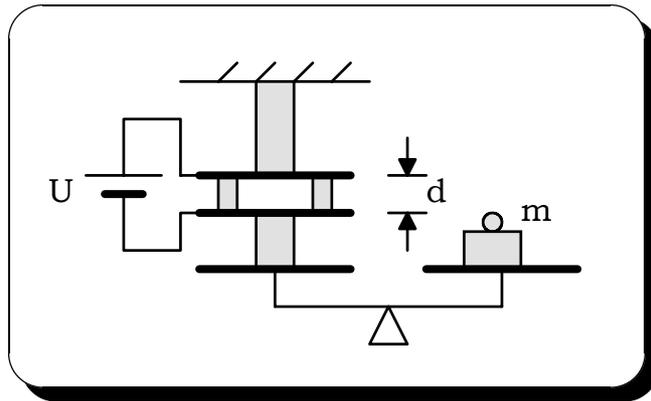
Ergebnis: Der Waagebalken mit der Kondensatorplatte und der Zusatzmasse  $m$  sinkt erst, wenn die Spannung  $U$  unter einen bestimmten Wert abgesunken ist; dann ist die Kraft zwischen den Platten genau so groß wie das Gewicht der Zusatzmasse  $m$ . Man erhält zum Beispiel für  $U = 5 \text{ kV}$ ,  $d = 2 \text{ mm}$  und  $A = 400 \text{ cm}^2$  die Kraft  $F = 1 \text{ N}$ .
