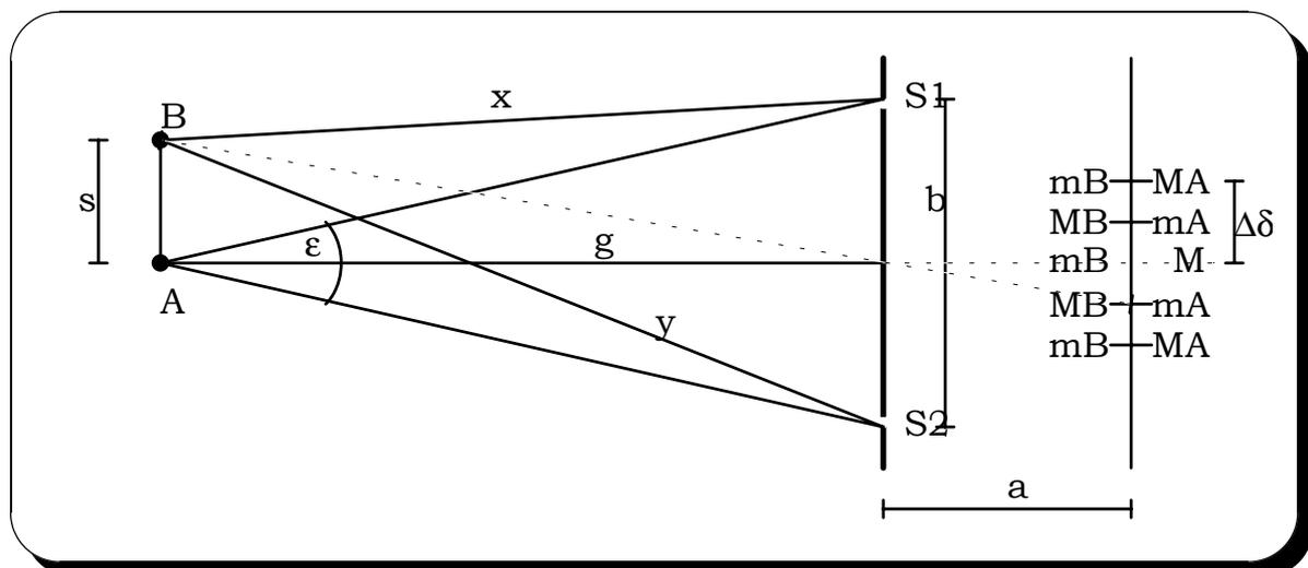
Die vom Punkt A auf der optischen Achse AM ausgehenden Wellenzüge rufen in den beiden Öffnungen  $S_1$  und  $S_2$  des Doppelspalts gleichphasige Elementarwellen hervor, die auf dem Schirm die bekannten Interferenzstreifen mit einem Maximum in M hervorrufen. Pausen zwischen den Ausstrahlungen der einzelnen Wellenzüge vom selben Punkt A nimmt das Auge nicht wahr.
