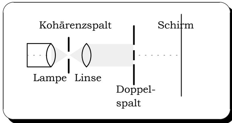
Das Licht der Lampe fällt auf den Doppelspalt. Zwischen Lampe und Doppelspalt befinden sich ein Beleuchtungsspalt (Kohärenzspalt); dieser steht im Brennpunkt einer Sammellinse, die den Spalt auf den Beobachtungsschirm scharf abbildet.
