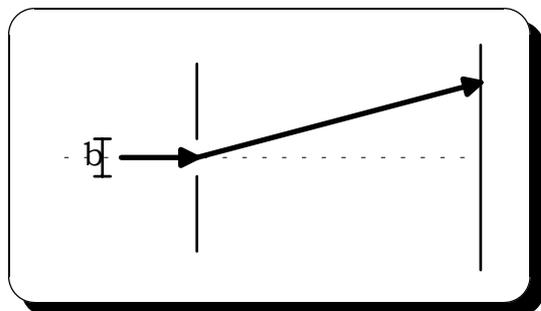
Laserlicht fällt auf einen verstellbaren Spalt, hinter dem ein Auffangschirm steht.
