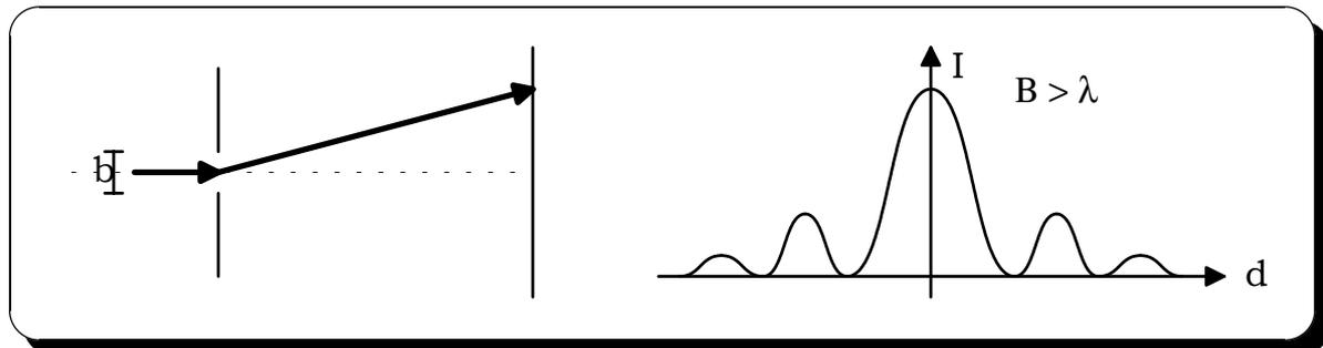
Laserlicht fällt auf einen Spalt der variablen Breite  $B$ , hinter dem ein Auffangschirm steht.
