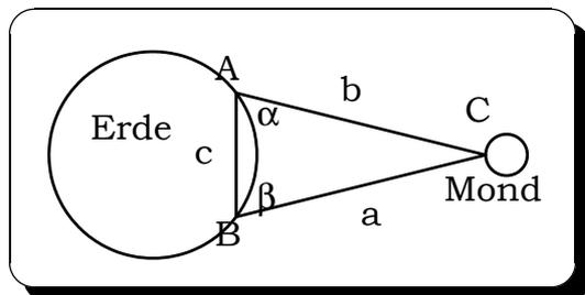
Die Entfernung des Mondes z. B. vom Punkt A erhält man bei bekannter Entfernung  $c$  zwischen A und B mit dem Sinussatz durch Messung der Winkel  $\alpha$  und  $\beta$ :
