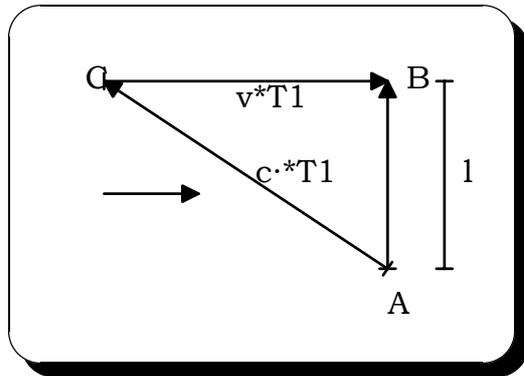
Damit das bei ausgesandte Signal bei B ankommt, muss es wegen der Abdrift in Richtung auf C losgeschickt werden bzw. bei Windstille würde es bei C ankommen.
