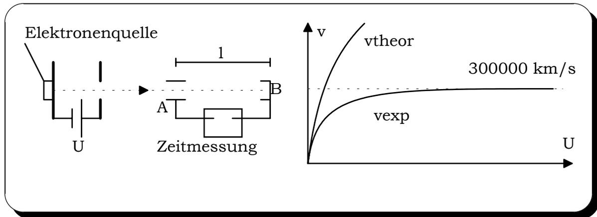
Die Teilchen des Elektronenpulses lösen durch Influenz bei A und B die Zeitmessung aus. Durch Messung der Erwärmung des Faraday-Behlers B kann die kinetische Energie der ankommenden Elektronen bestimmt werden.
