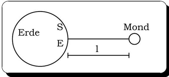
Unter den Annahmen geradlinigen Signalausbreitung und konstanter Signalgeschwindigkeit  $c$  folgt  $c = \frac{2l}{T} \Rightarrow l = \frac{c \cdot T}{2}$ .
